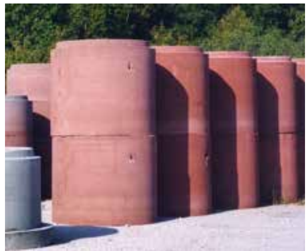
Fosos de registro en concreto prefabricado con tecnología decristalización que incorpora un pigmento rojo para facilitar su identificación.
