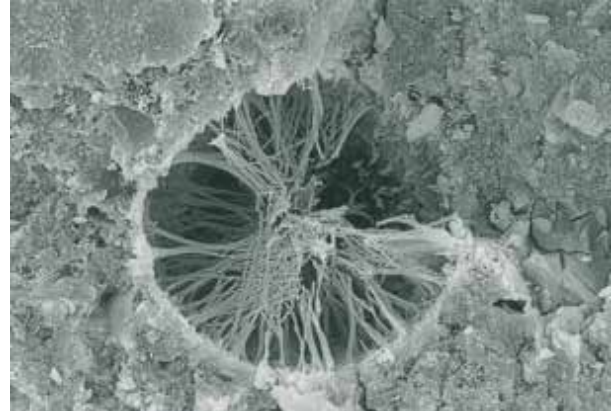
Formación de cristalización en un poro de concreto tomada con microscopio electrónico.
