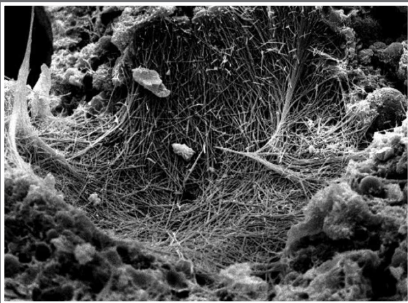
CONCRETO TRATADO CON XYPEX
