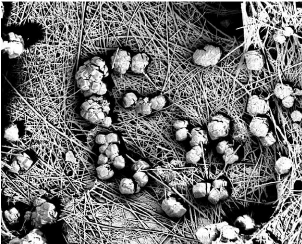
CONCRETO TRATADO CON XYPEX (60% CEMENTO MEZCLADO CON ESCORIAS)
