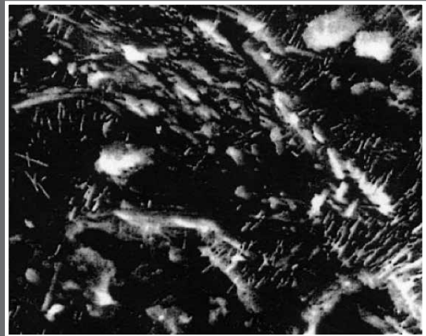
CONCRETO TRATADO CON XYPEX
