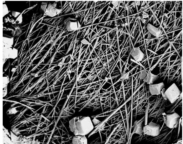
CONCRETO TRATADO CON XYPEX (30% CEMENTO MEZCLADO CON CENIZA VOLANTE)
