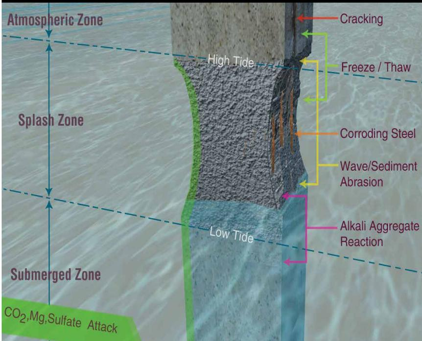
El propósito primario de la impermeabilización de las estructuras marinas es la protección del acero de refuerzo contra los efectos dañinos de la corrosión. La naturaleza propia del concreto y los problemas asociados con su colocación y consolidación significan tener que lidiar con problemas de permeabilidad que permiten el ingreso de agua al sustrato y hasta el acero de refuerzo. Con la presencia de oxígeno, se inicia el proceso de corrosión.
