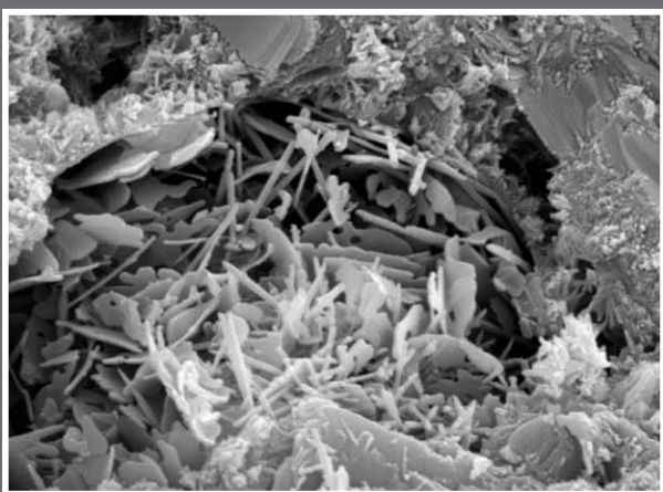
BETON TRETIRAN XYPEX-OM
