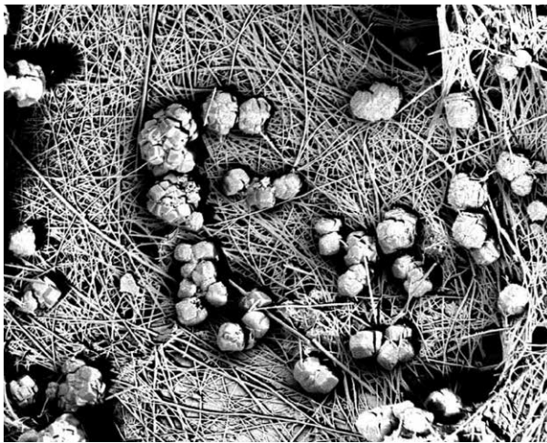
BETON TRETIRAN XYPEX-OM (60% SMJESA CEMENTA I TROSKE)
