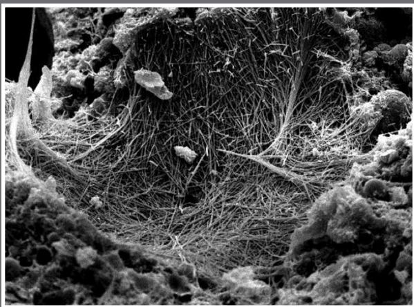
BETON TRETIRAN XYPEX-OM
