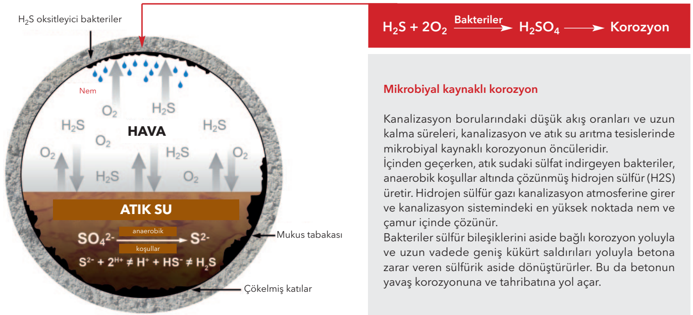
Şek. 1: Mikrobiyal kaynaklı korozyon (MIC), betonu ve çeliği hızla yok edebilen güçlü asitler üreten karmaşık, biyokimyasal bir süreçtir.
