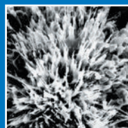
Хурех Crystallization (бетон после выдерживания)
