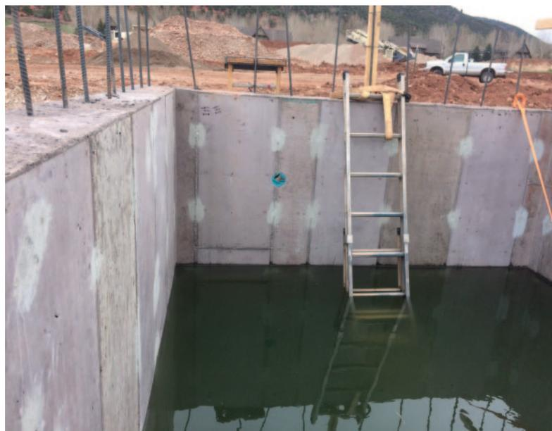
Fig. 8: Il test idrostatico è riuscito al primo tentativo.
