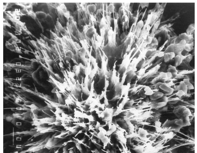
Mit kristalliner Formation gefüllte Betonpore unter einem Rasterelektronenmikroskop
