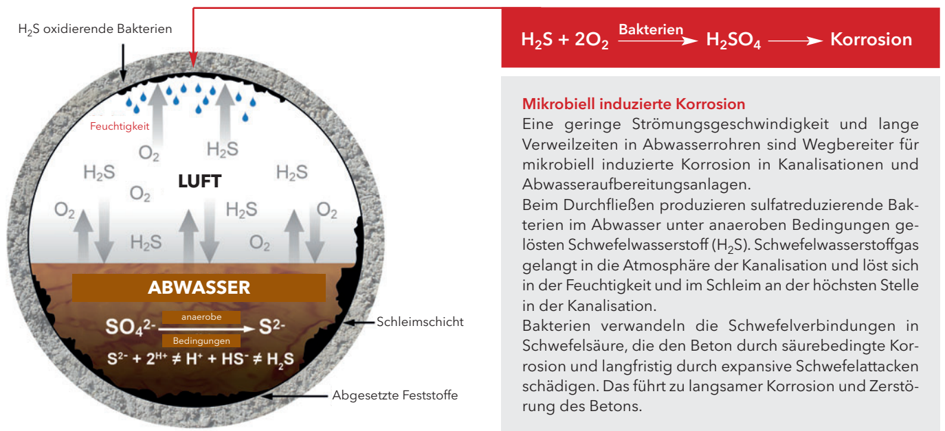
Abb. 1: Mikrobiell induzierte Korrosion (MIC) ist ein komplexer, biochemischer Prozess, bei dem starke Säuren entstehen, die Beton und Stahl schnell zerstören können.
